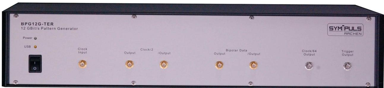
Breitbandig durchstimmbarer Patterngenerator für bipolare Return-to-Zero und Non-Return-to Zero Impulse mit einer maximalen Datenrate von 6 GHz.
