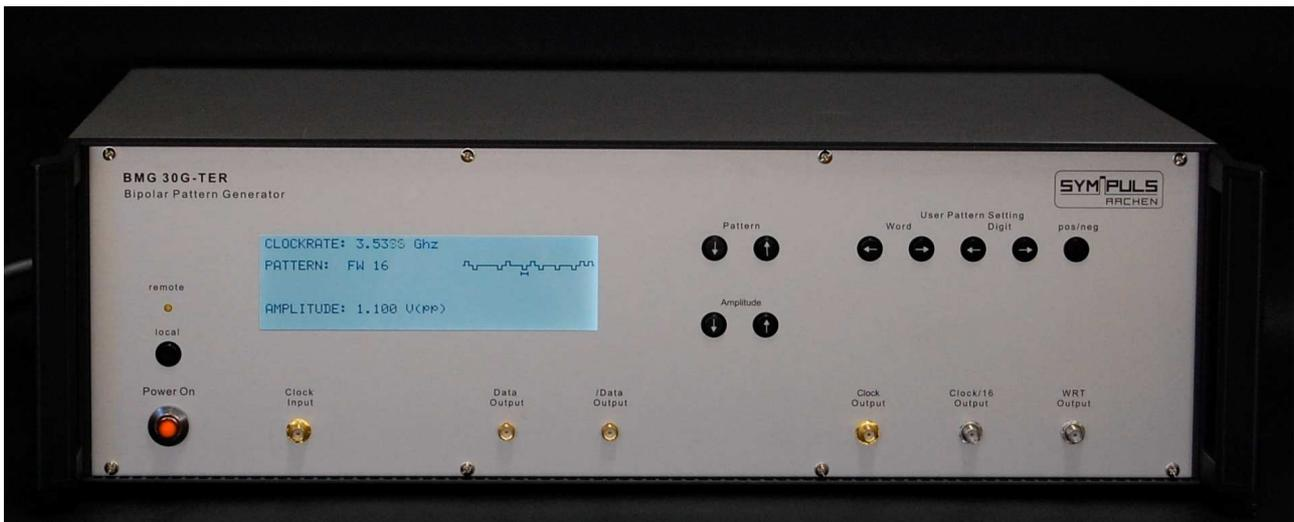
Breitbandig durchstimmbarer Patterngenerator für bipolare Return-to-Zero Impulse (Ternärkode) mit einer maximalen Datenrate von 15 GHz.
